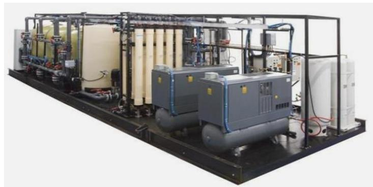
**Figure 1.** Une unité modulaire du système Dagua-BWT-UF
